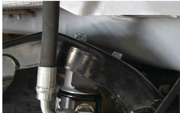
Fig. 33: Attach the top hat nuts.
