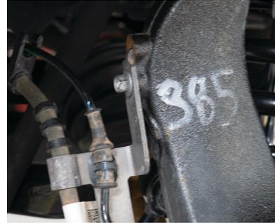
Fig. 21: Brake bracket bolt.
