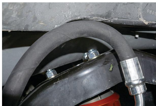
Fig. 35: Attach the top hat nuts.
