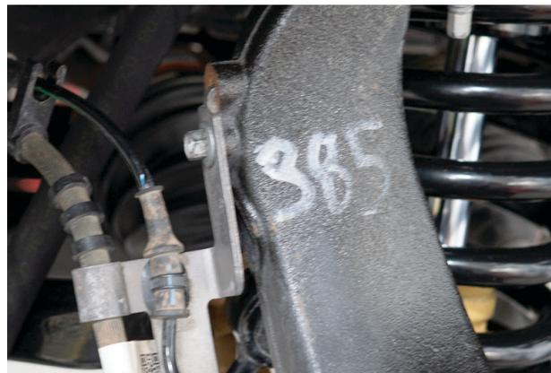
Fig. 18: Brake bracket bolt.
