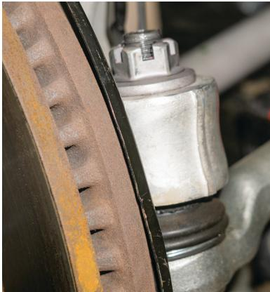
Fig. 14: Tie rod end link.
