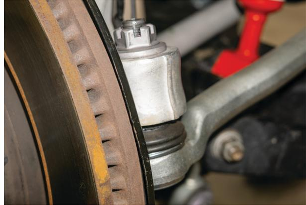
Fig. 12: Tie rod end link.
