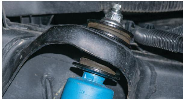
Fig. 17: Remove stem top nut.
